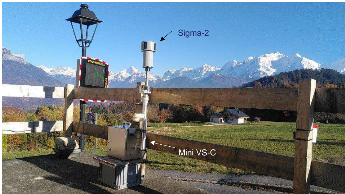
Figure 14: Collecteur passif Sigma-2 (en haut) pour l'échantillonnage passif des PM_{10-2.5} et Mini VS-C Leckel (en bas) pour l'échantillonnage actif des PM_{2.5} installés à la station de mesure Cordon centre.
