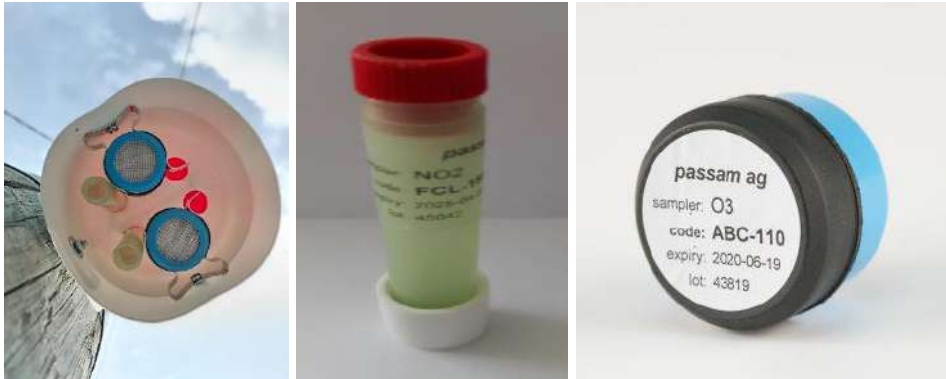
Figure 13: Photographie d'une installation des tubes \text{NO}_2 et \text{O}_3 (à gauche), tube \text{NO}_2 (au milieu) et tube \text{O}_3 (à droite).
