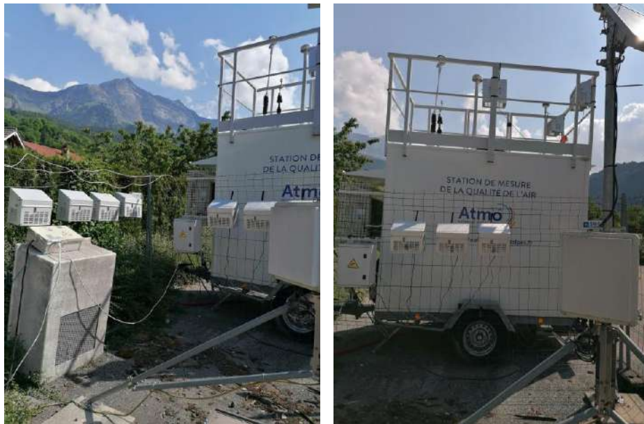
Figure 17: Photographie des micro-capteurs WT1 en inter-comparaison à la station Atmo Passy.
